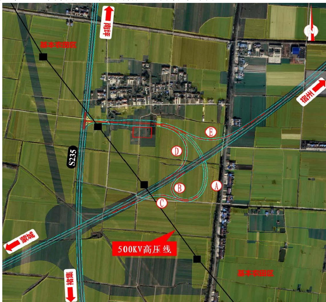
图 2.1-12 双堆集南互通平面布置示意图
