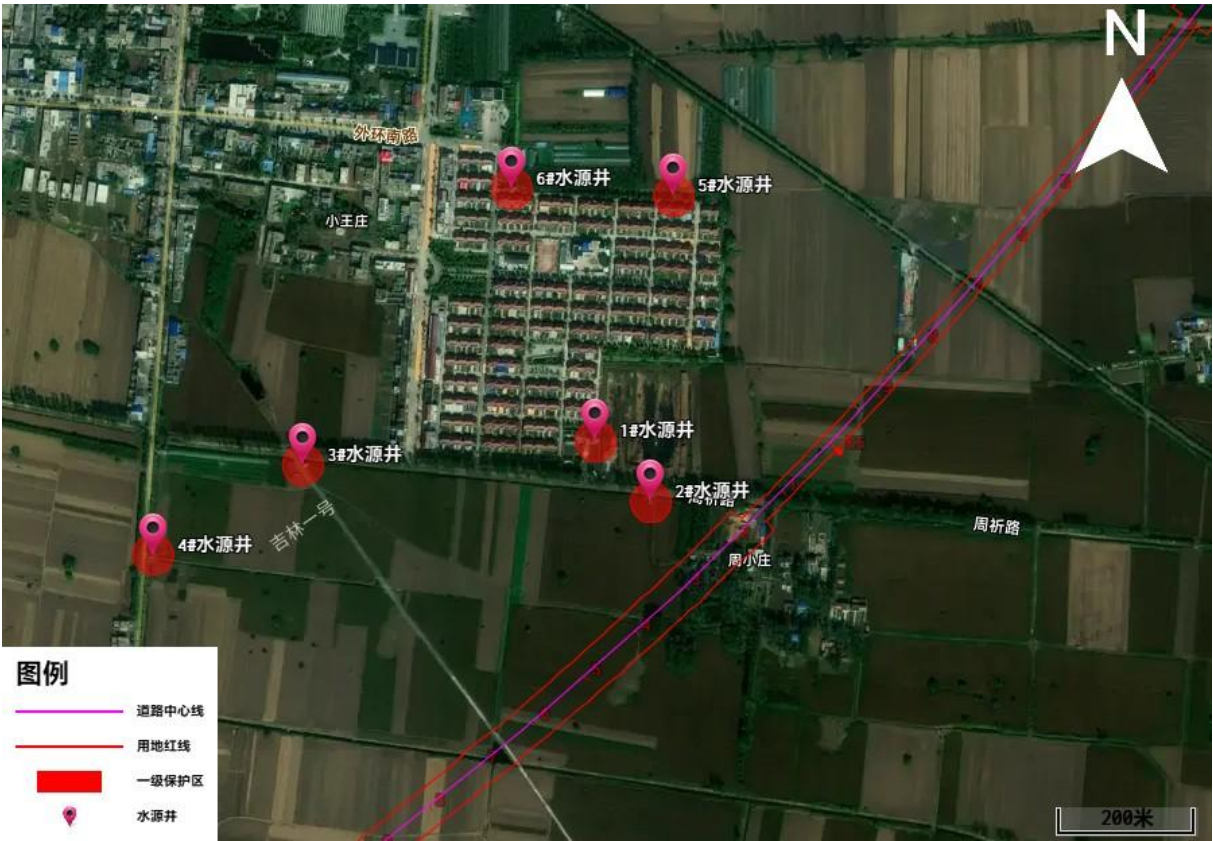
图 1.9-1 项目路线与双堆水厂地下水水源井位置关系图
