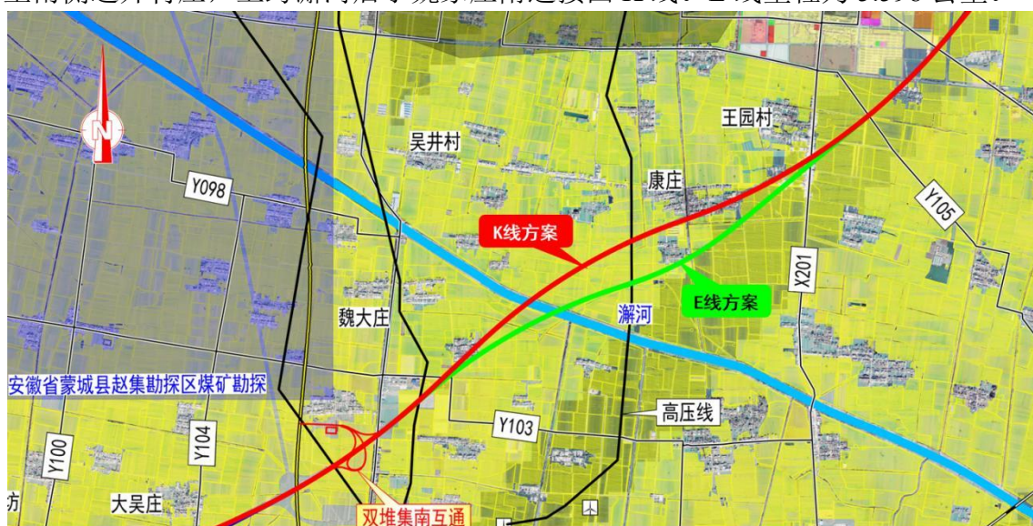
图 2.1-3 K 线方案与 E 线方案比选示意图
